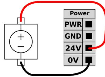
Este ejemplo ilustra la configuración predeterminada utilizando la fuente de alimentación interna
