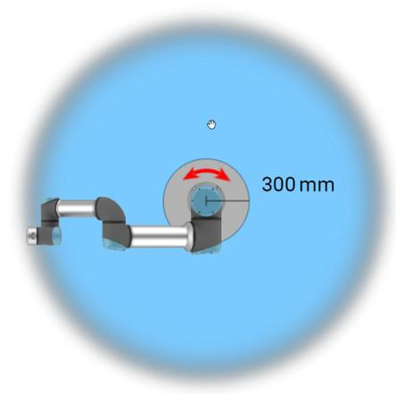
*Debido a las propiedades físicas del brazo robótico, determinadas zonas de espacio de trabajo requieren atención en relación con los peligros de pinzamiento. Se define un área (izquierda) para movimientos radiales cuando la articulación de la muñeca 1 está al menos a 800 mm de la base del robot. La otra área (derecha) está a 300 mm de la base del robot al moverse tangencialmente.*
