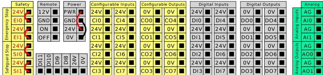
Puede utilizar el bloque de entradas digitales horizontal (DI8-DI11), ilustrado abajo, para el seguimiento de cinta transportadora con codificación en cuadratura.
